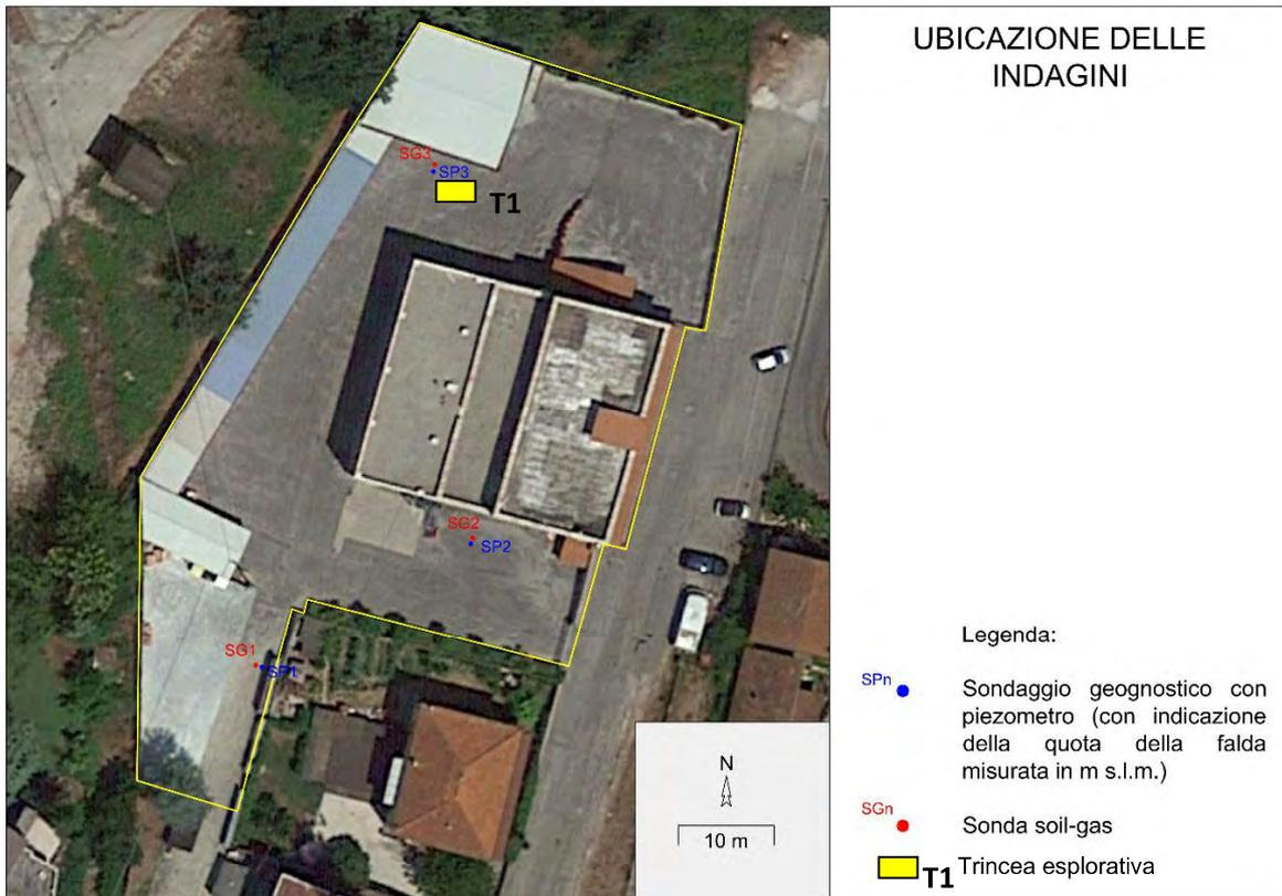
Figura 2 – Ubicazione della trincea esplorativa da eseguire ad integrazione delle indagini già condotte (sondaggi geognostici con piezometri e sonde soil-gas)
