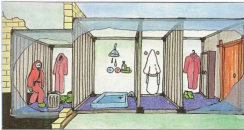
Esempio schematico della composizione di un'unità di decontaminazione del personale
