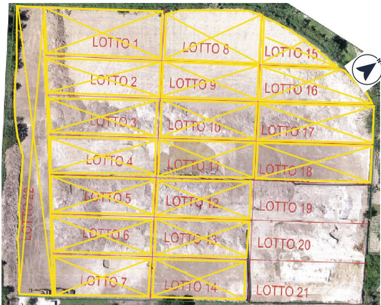
Piano di campionamento terreni dal fondo scavo dei Lotti. Le direttrici in giallo indicano i perimetri e le diagonali di ciascun Lotto dove sono stati prelevati i terreni che resi omogenei sono andati a costituire, per ciascun Lotto, un unico campione mediato.
