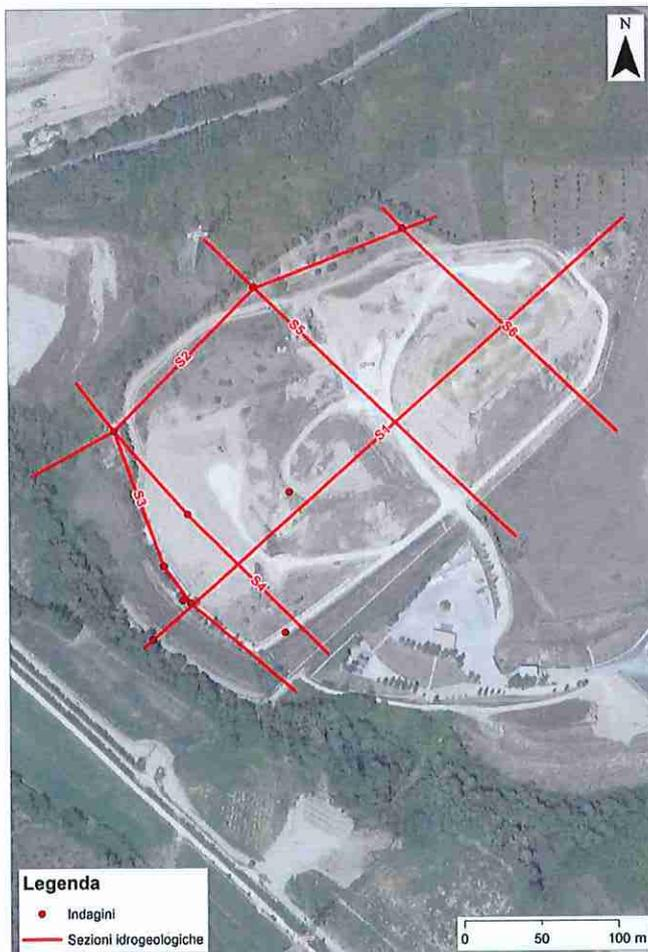
Fig. 2.2.3 – Planimetria con l'ubicazione delle tracce delle sezioni litologiche/idrogeologiche di figg. 2.2.4÷2.2.9 e delle stratigrafie reperite ed utilizzate per le ricostruzioni
