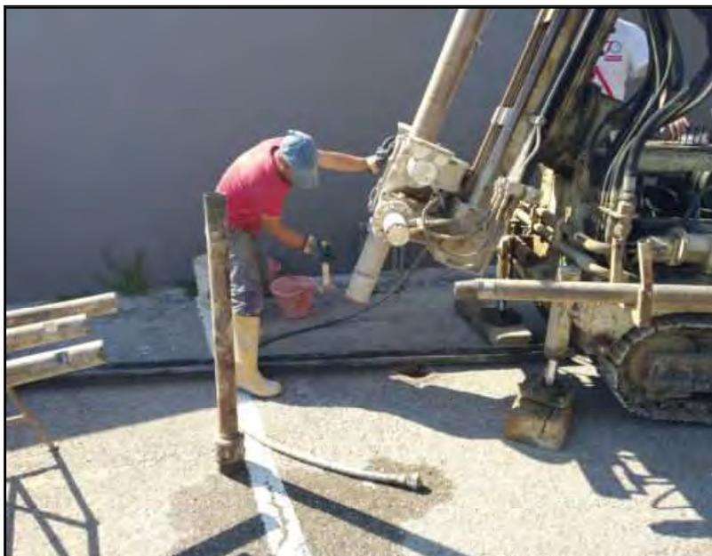
**Fig.3**– Battitura del carotiere per il recupero del campione di terreno
