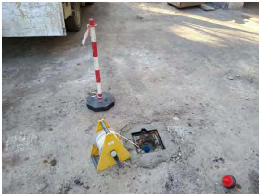
**Fig.10**– Misurazione livello piezometrico mediante sonda freaticometrica
