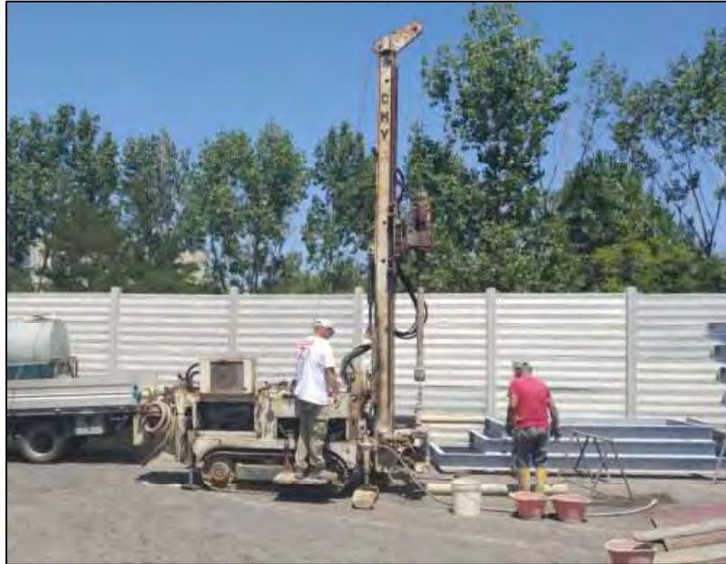
**Fig.2**– Sonda cingolata CMV 420
