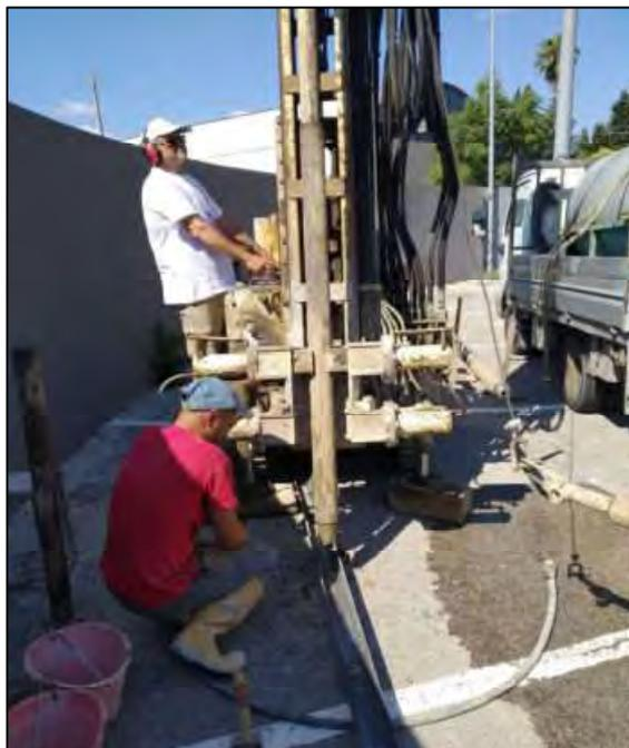
**Fig.4**– Estrattore a pressione del carotiere per il recupero del campione di terreno.
