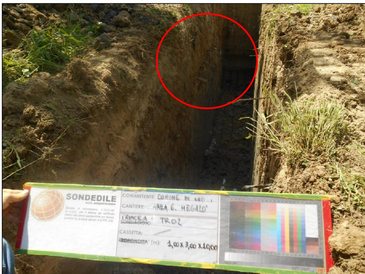
Figura 9 Particolare delle pareti di scavo della trincea TR2 con presenza di rifiuti (1/2).
