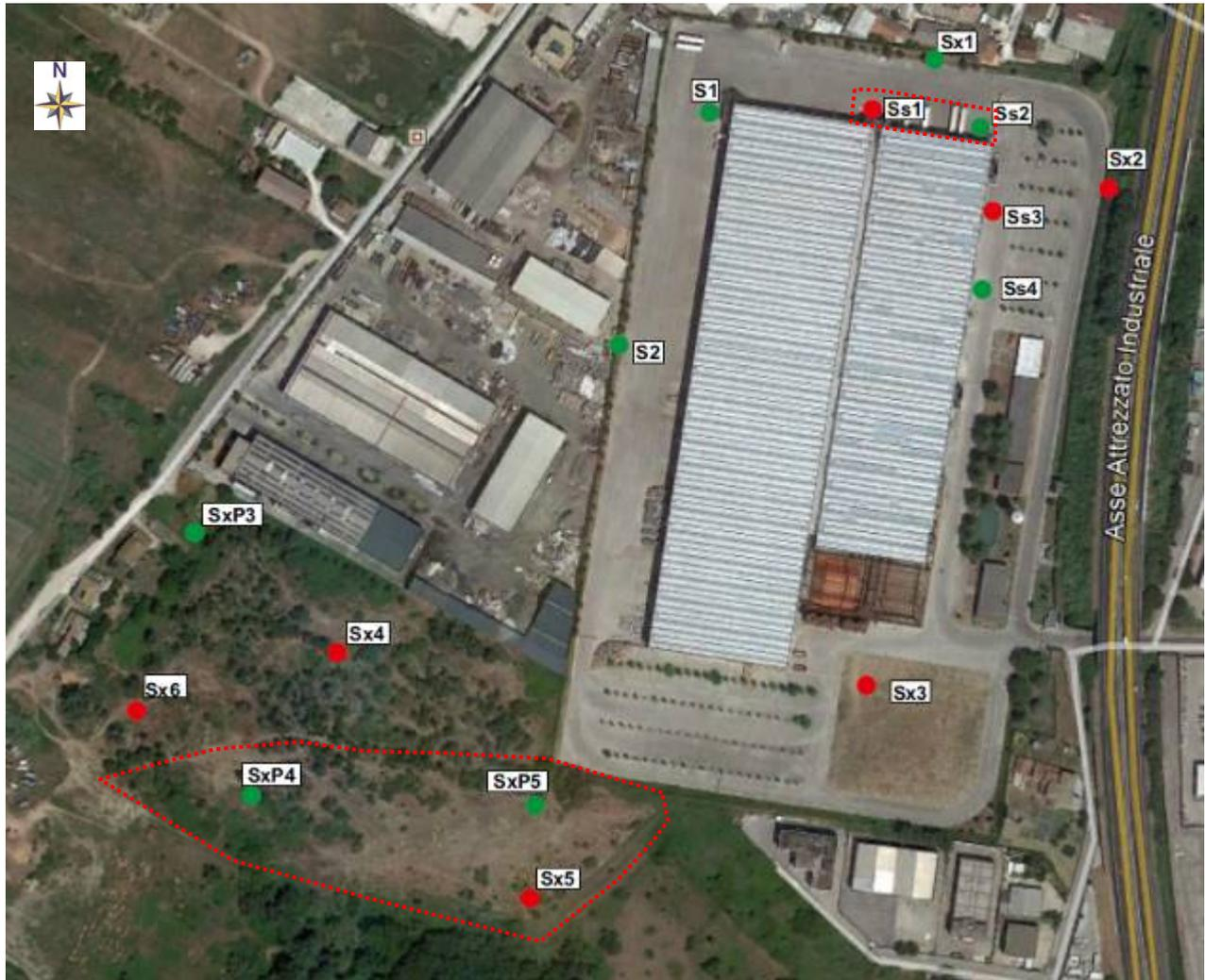
Delimitazione schematica delle aree all'interno del sito, caratterizzate da rinvenimenti di scorie di fusione in quantità e spessori variabili. Nei punti SS1 ed SS2 solo tracce, in SXP4, SXP5 ed SX5 spessori consistenti.
