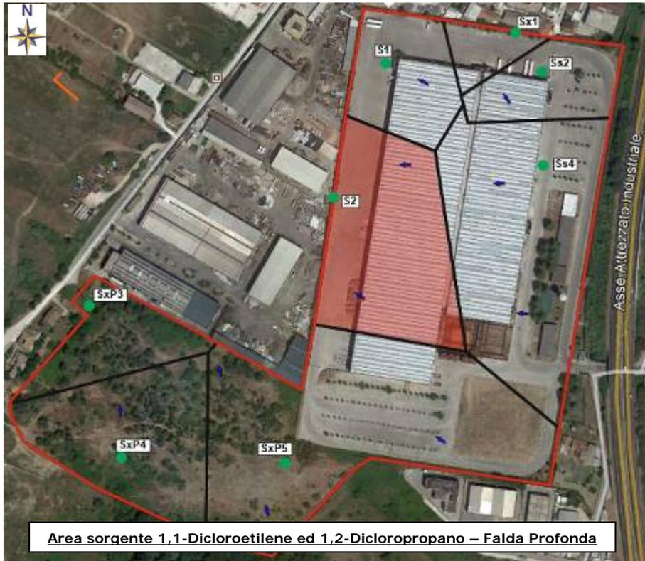
*Poligoni di Thiessen per l'analita 1,1-Dicloroetilene ed 1,2-Dicloropropano nella falda profonda. In rosso evidenziata l'area sorgente. In Arancio direzione del vento ed in blue direzione della falda profonda.*
