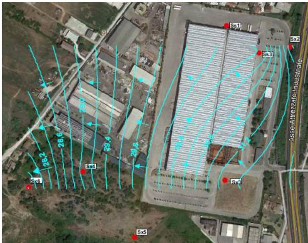
Ricostruzione della superficie piezometrica della falda superficiale, con indicate le direzioni di deflusso.
