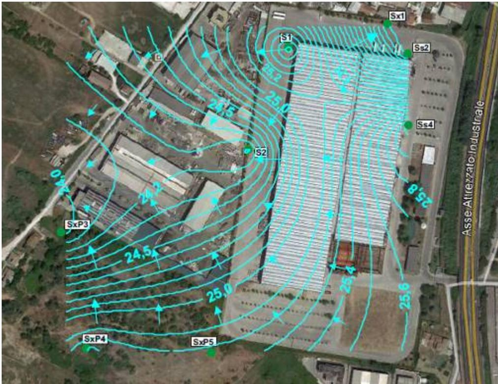
Ricostruzione della superficie piezometrica della falda profonda, con indicate le direzioni di deflusso.
